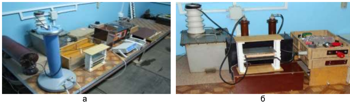
Рисунок 1 – Варианты комплектования экспериментальных установок для обработки семян в электрическом поле: а – с использованием аппарата СКАТ-70; б – с применением высоковольтного трансформатора и блока выпрямления
