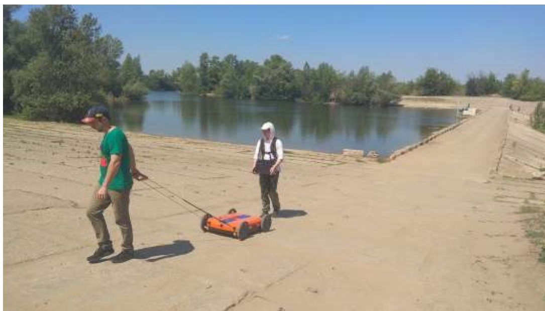
Рисунок 1 – Георадарная съемка объекта исследования антенным блоком АБ 150/400
