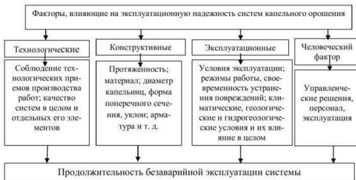
Рисунок 3 – Структурная схема факторов влияющих на продолжительность безаварийной эксплуатации системы капельного орошения Figure 3 – Structural diagram of factors influencing duration trouble-free operation of the drip irrigation system
