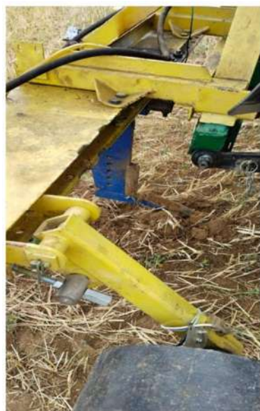
Рисунок 4 – Эффект налипания частиц почвы на экспериментальные рабочие органы.
