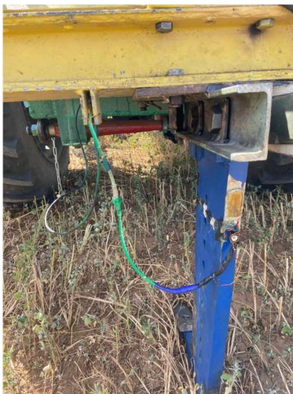
Рисунок 8 – Измерение горизонтальной составляющей тягового сопротивления чизельной стойки
