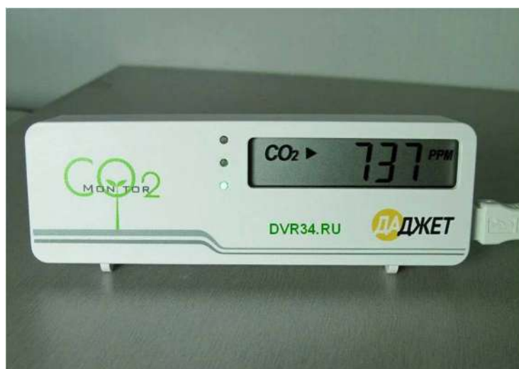
Рисунок 3 – Детектор для определения уровня углекислого газа Figure 3 – Carbon dioxide detector
