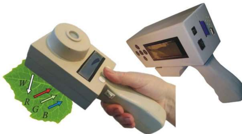
Рисунок 2 – Измеритель цвета (слева) и листовой фотоколориметр (справа) Figure 2 – Color meter (left) and leaf photocolorimeter (right)
