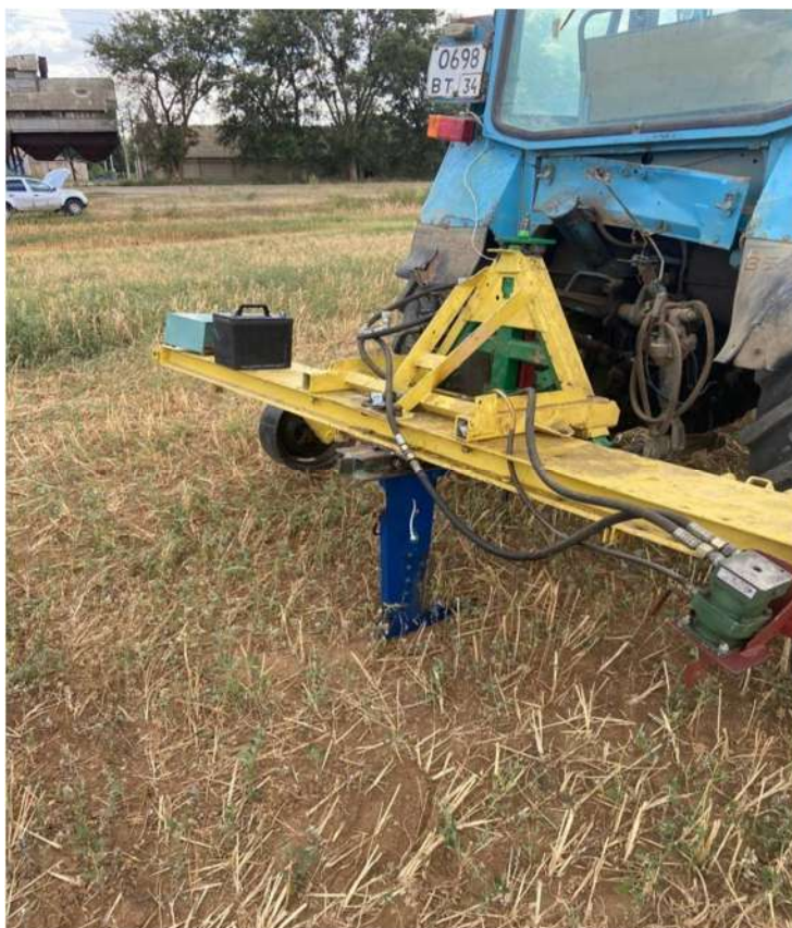
Рисунок 3 – Общий вид экспериментальной установки по определению тягового сопротивления рабочей секции чизельного орудия
