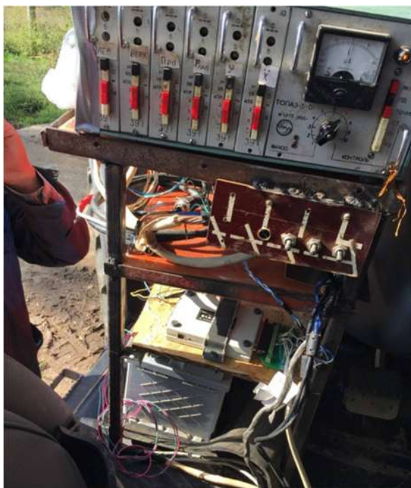
Рисунок 10 – Система регистрации измеряемых параметров Figure 10 – System for recording measured parameters
