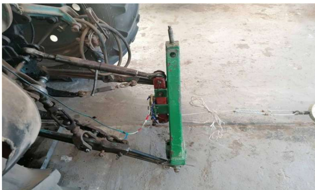
Рисунок 6 – Общий вид устройства для измерения горизонтального усилия от сельскохозяйственной машины, навешиваемой на трактор Figure 6 – General view of a device for measuring the horizontal force from an agricultural machine mounted on a tractor
