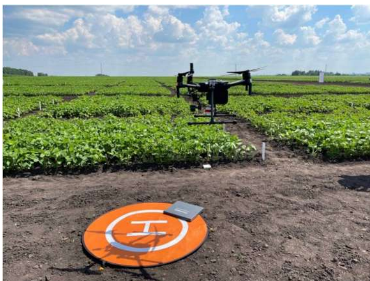
Рисунок 1 – БПЛА DJI Matrice 200 v2 с мультиспектральной камерой MicaSense Altum (съемка 28 июня 2022 года)
