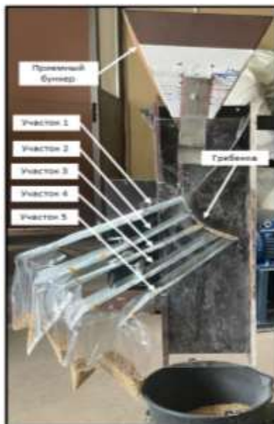
Рисунок 3 – Общий вид макетного образца гравитационной колонки
