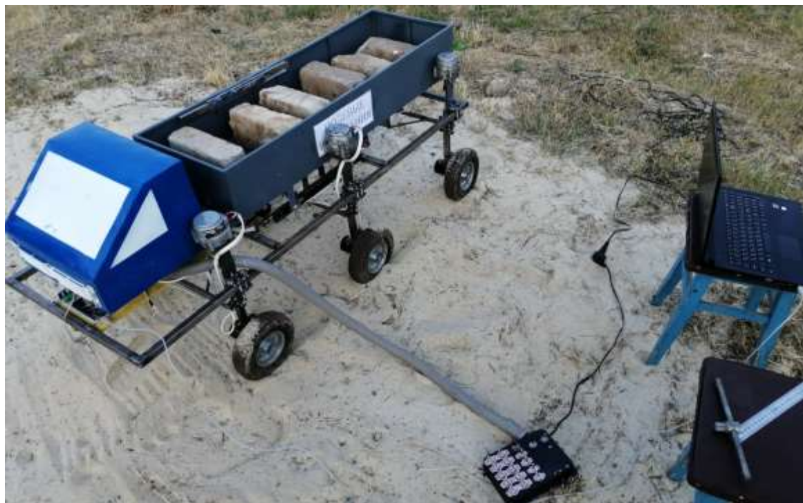
Рисунок 2 – Общий вид проведения полевых испытаний экспериментального транспортного средства при передвижении по основанию сухой сыпучий песок
