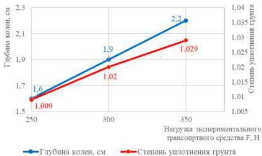
Рисунок 5 – Исследование изменения глубины колеи и степени уплотнения грунта в зависимости от нагрузки экспериментального транспортного средства при передвижении способом качения по основанию сухой сыпучий песок Figure 5 – Study of changes in rut depth and degree of soil compaction depending on the load of an experimental vehicle when moving by rolling on a base of dry bulk sand
