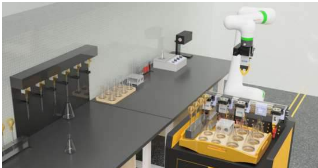
Рисунок 2 – Гибридный робот на базе коллаборативного манипулятора, разработанный для перемещения образцов в пределах лаборатории
