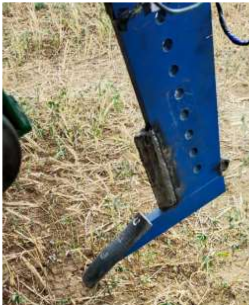
Рисунок 1 – Рабочая секция чизельного плуга с улучшенной геометрией поверхности рабочего органа
