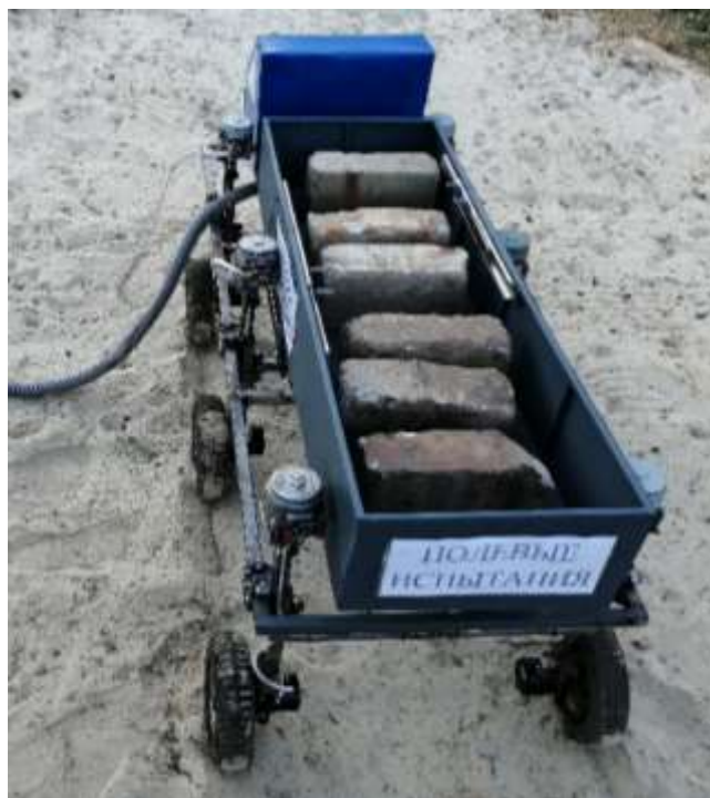
Рисунок 4 – Фрагмент передвижения способом качения экспериментального транспортного средства по основанию сухой сыпучий песок
