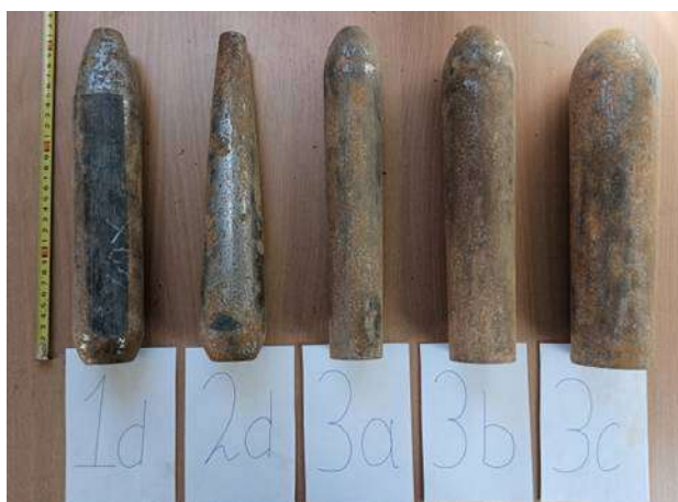
Рисунок 4 – Формы уширителя для кротователя № 3 Figure 4 – Forms of expander for mole maker No. 3
