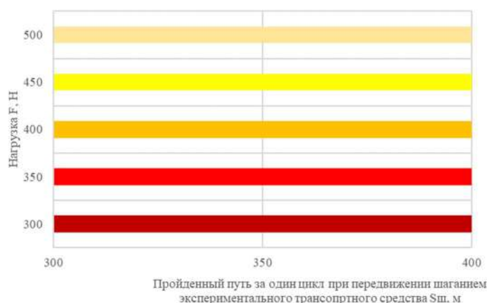
Рисунок 6– Исследование изменения пройденного пути в зависимости от нагрузки экспериментального транспортного средства при передвижении способом шагания по основанию «влажный вспаханный грунт»
