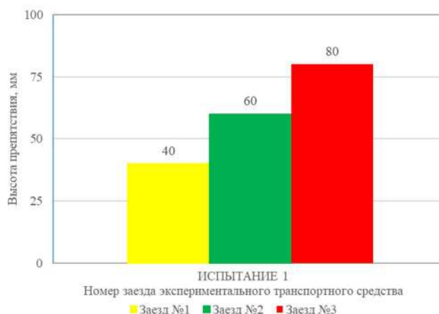
Рисунок 12 – Исследование преодоления препятствия наибольшей высоты экспериментальным транспортным средством способом качения
