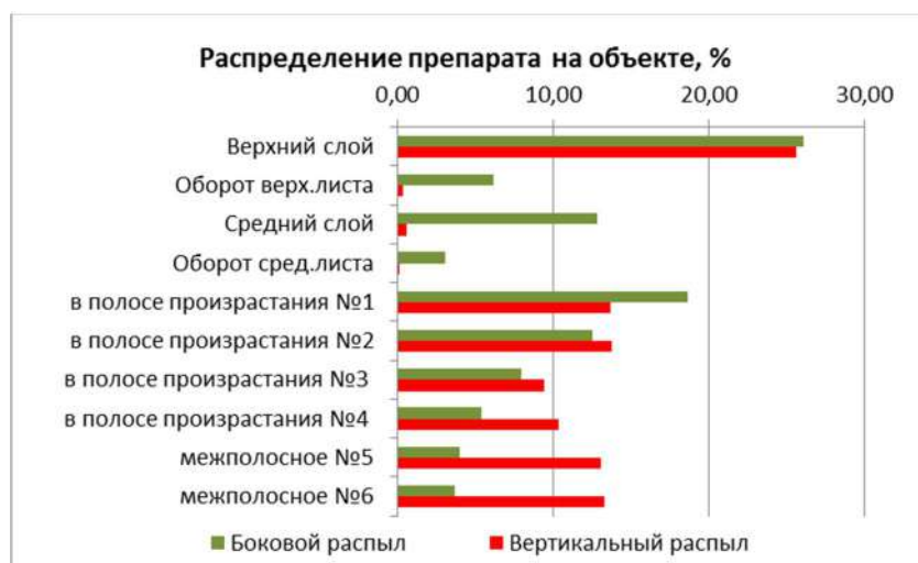
Рисунок 7 – Распределение препарата на объекте обработки от способа опрыскивания по ярусам Figure 7 – Distribution of the preparation on the object of treatment from the method of spraying by tiers
