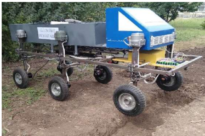
Рисунок 9 – Исследование преодоления рва экспериментальным транспортным средством способом шагания Figure 9 – Study of overcoming the moat by the experimental walking way
