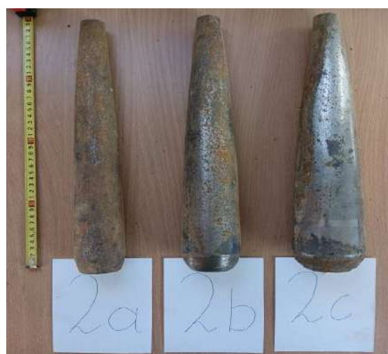
Рисунок 3 – Формы уширителя для кротователя № 2 Figure 3 – Forms of expander for mole maker No. 2
