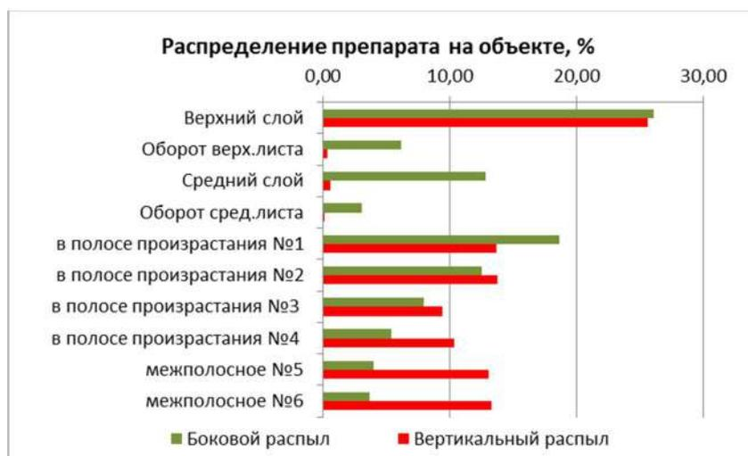
Рисунок 7 – Распределение препарата на объекте обработки от способа опрыскивания по ярусам
