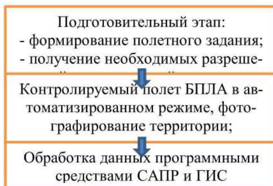
Рисунок 1 – Порядок дистанционного обследования сельскохозяйственных полей с помощью БПЛА
