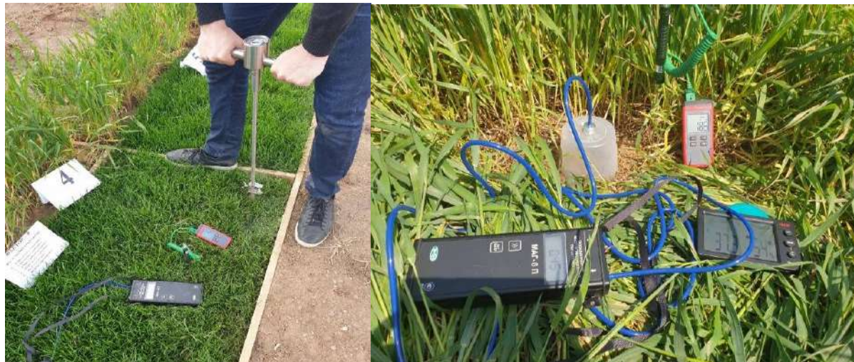
Рисунок 3 – Исследование температуры и плотности почвы по вариантам Figure 3 – Study of soil temperature and density by variants
