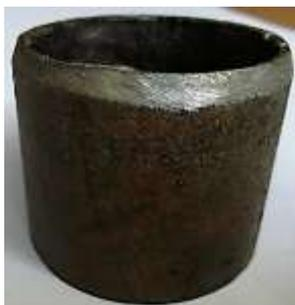
Рисунок 7 – Общий вид режущего кольца
