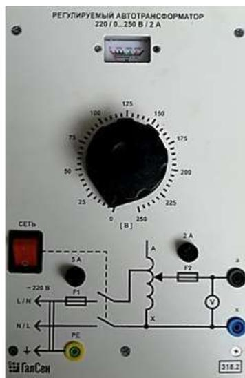
Рисунок 1 – Общий вид регулируемого автотрансформатора
