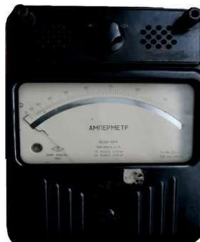
Рисунок 4 – Общий вид амперметра модели Д566
