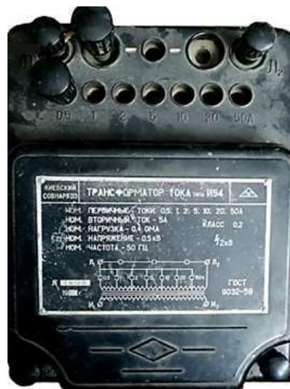
Рисунок 2 – Общий вид трансформатора тока типа И54
