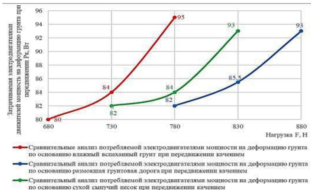
Рисунок 11 – Сравнительный анализ затрачиваемой электродвигателями мощности на деформацию грунта при передвижении способом качения экспериментального транспортного средства
