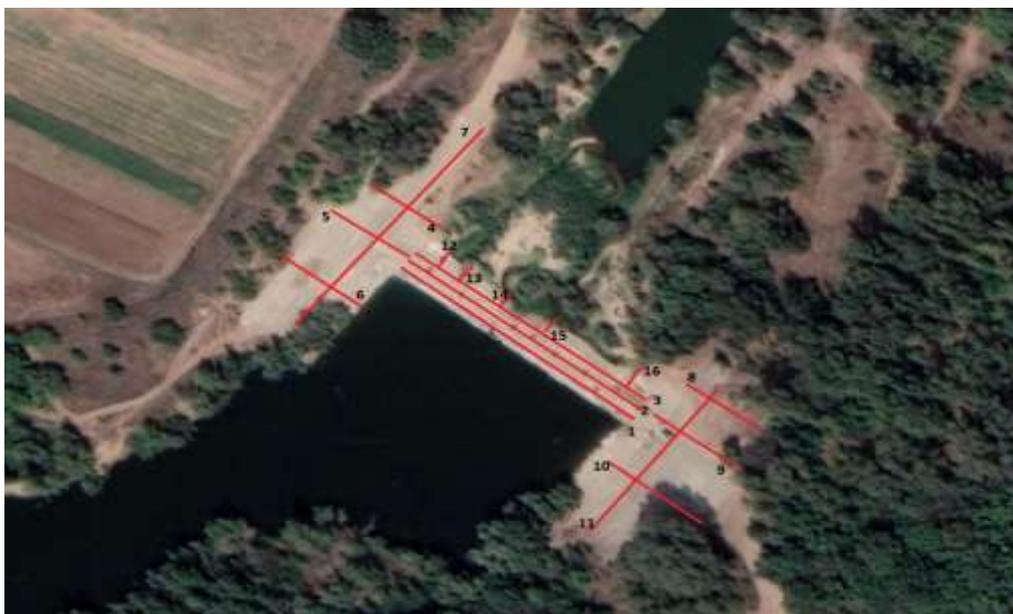
Рисунок 2 – Схема расположения георадарных профилей
