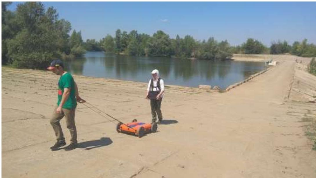
Рисунок 1 – Георадарная съемка объекта исследования антенным блоком АБ 150/400
