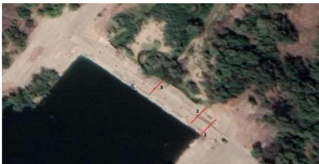
Рисунок 8 – Участки локального повышения влажности грунта, пересекающие тело плотины
