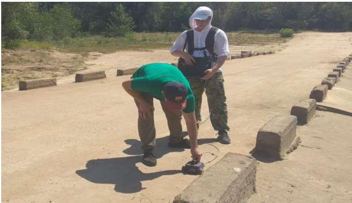
Рисунок 3 – Сканирование плотины бетоноскопом АБ-1700
