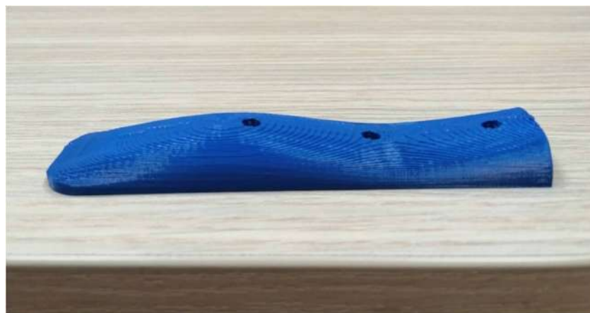
Рисунок 2 – Модель экспериментального рабочего органа, полученная по средствам 3D – печати
