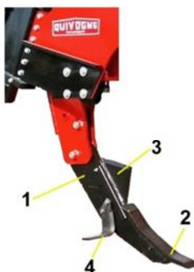
Рисунок 7 – Состав рабочего органа чизельного рыхлителя Figure 7 – Composition of the working body of the chisel ripper
