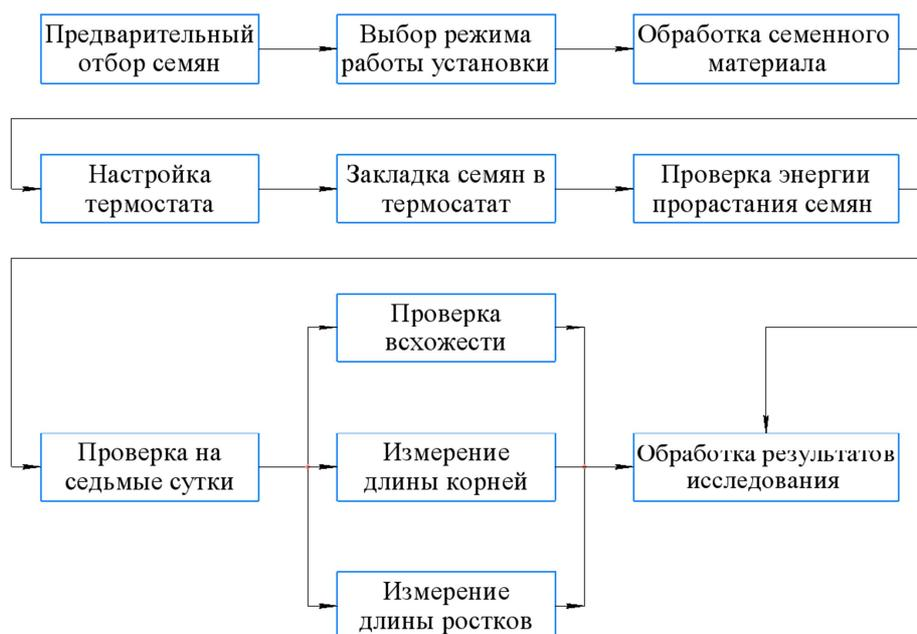
Рисунок 1 – Структурная схема проведения экспериментальных исследований
