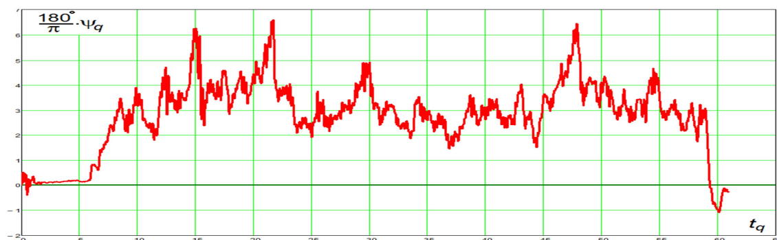
Рисунок 4 – График зависимости угла (в градусах) поворота лапы от времени Figure 4 – Graph of the dependence of the angle (in degrees) of the paw rotation on time
