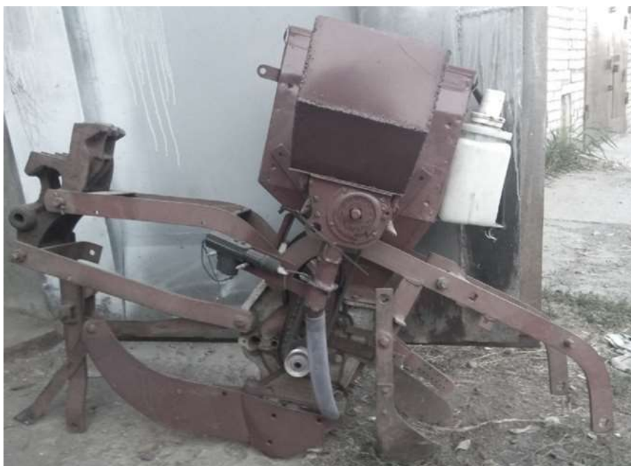
Рисунок 2 – Общий вид секция для посева семян сои одновременно с насыщенным гидрогелем Figure 2 – General view section for sowing soybean seeds simultaneously with saturated hydrogel
