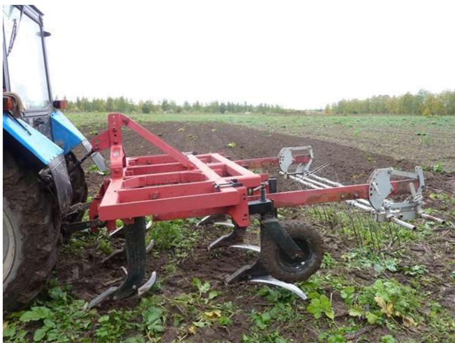
Рисунок 1 – Общий вид комбинированной почвообрабатывающей машины КПМ-2.7 с рабочими органами серпообразной формы в агрегате с трактором МТЗ-82.1
