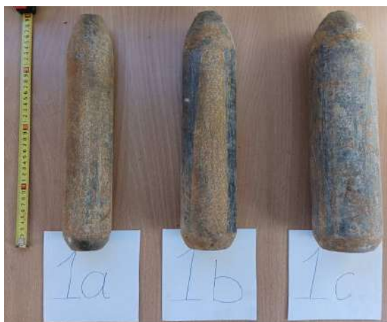
Рисунок 2 – Формы уширителя для кротователя № 1 Figure 2 – Forms of expander for mole maker No 1
