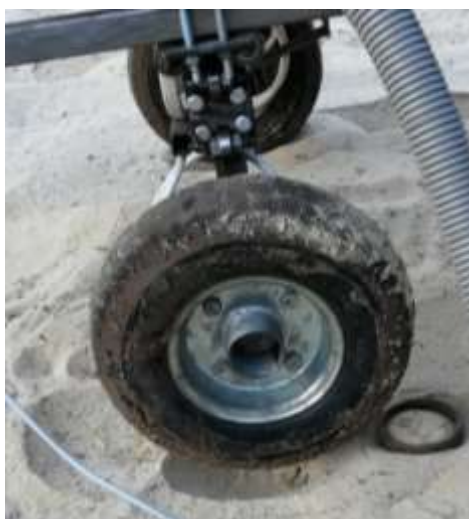
Рисунок 10 – Фрагмент определения степени уплотнения грунта при передвижении способом шагания экспериментального транспортного средства по основанию сухой сыпучий песок Figure 10 – Fragment of determining the degree of soil compaction when moving by walking an experimental vehicle on a base of dry bulk sand
