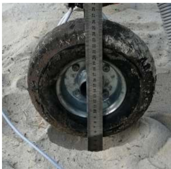
Рисунок 6 – Фрагмент определения глубины колеи при передвижении способом качения экспериментального транспортного средства по основанию сухой сыпучий песок Figure 6 – Fragment of determining the rut depth when moving by rolling an experimental vehicle on a base of dry bulk sand
